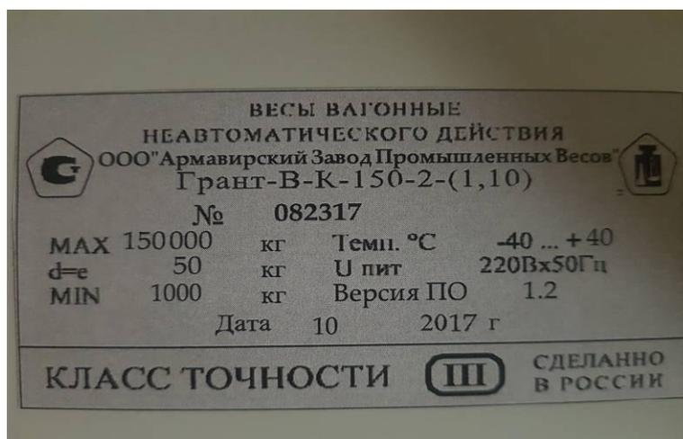
Рисунок 14 - Маркировка весов на грузоприемном устройстве и индикаторе или шкафе ШАВИ
