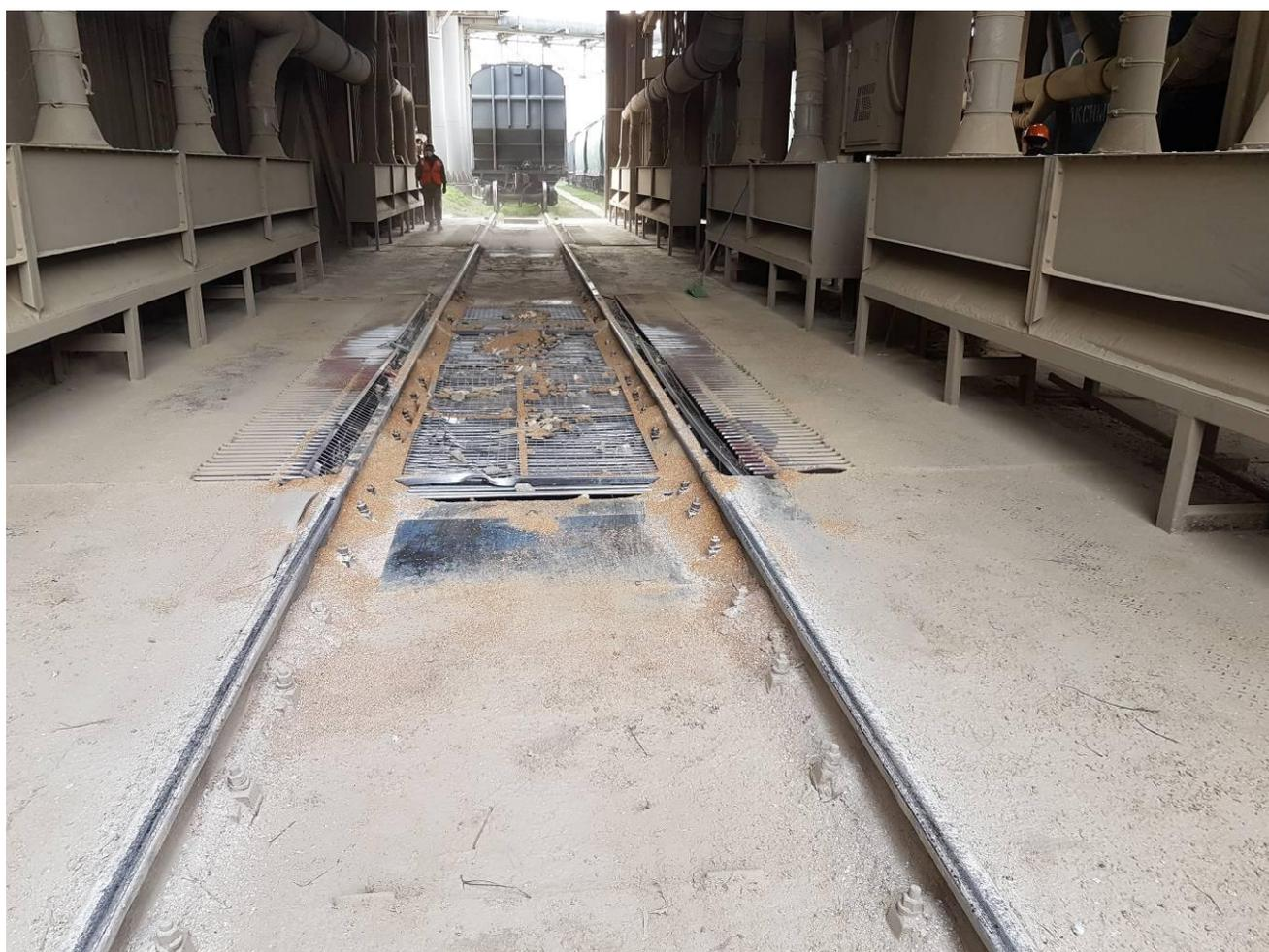
Рисунок 8 - Внешний вид весов вагонных неавтоматического действия Грант-В-К
